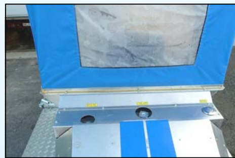
Lättåtkomlig dieseltank, kylare och hydrauloljetank för kontroll och påfyllning av vätskor.
