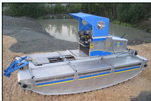
Den flyttbara förarplatsen regleras hydrauliskt och fungerar som motvikt vid tunga lyft i vatten.
