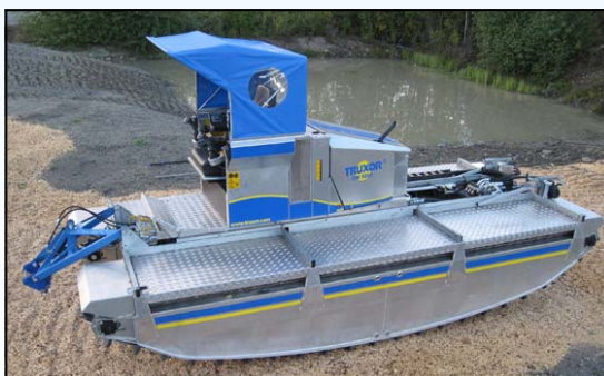
Den flyttbara förarplatsen regleras hydrauliskt och fungerar som motvikt vid tunga lyft i vatten.
