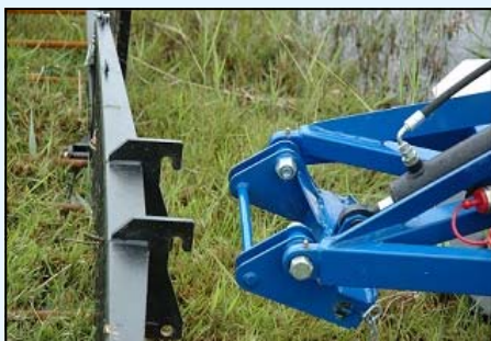
DM-fästet gör verktygsbytet enkelt.
