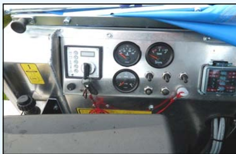
Instrumenten visar hydraultryck, bränslenivå, motortemperatur, hydrauloljetemperatur, timräknare, samt motorvarvtal.
