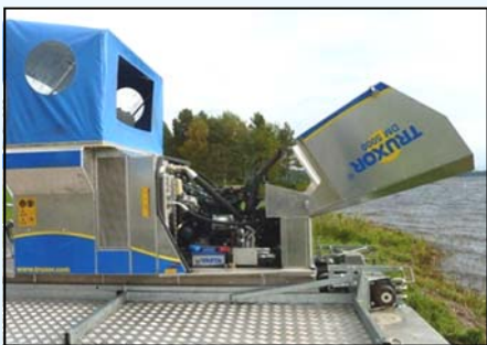
Öppningsbar motorhuv med verktygslåda integrerad i motorrummet.
