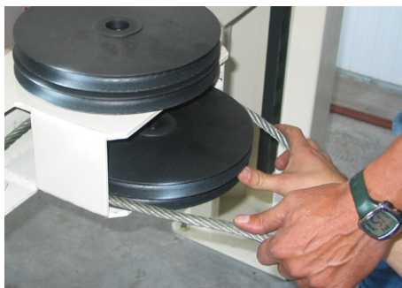
Abbildung 4.17 Montage der Stahlseile
