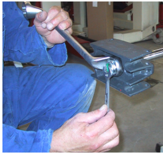
Rysunek 4.22 Montaż głowicy ruchomego trzpienia oraz wyciągnięcie trzonu tłokowego
