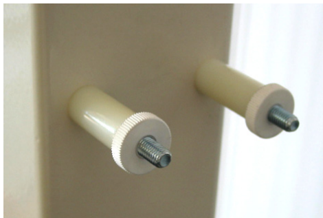
Abbildung 4.12 Distanzbuchsen - Montage Bedienungspult
