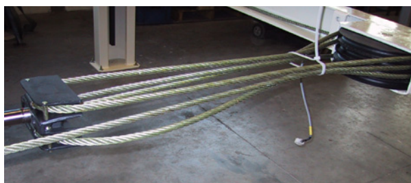
Figura 4.23 Fijación de los cables a la cabeza del émbolo
