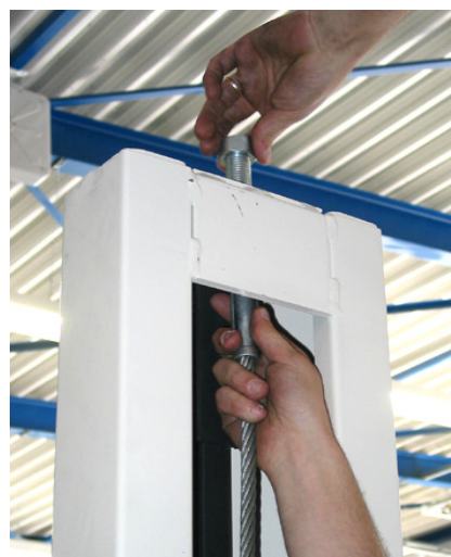
Figuur 4.20 Kabelverloop dwarsbalk I - II en in de kolommen
