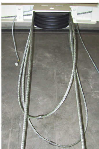
Figuur 4.20 Kabelverloop dwarsbalk I - II en in de kolommen
