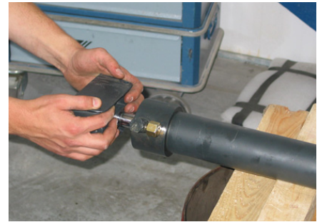
Rysunek 4.22 Montaż głowicy ruchomego trzpienia oraz wyciągnięcie trzonu tłokowego
