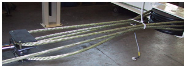
Abbildung 4.23 Befestigung der Kabel am Plungerkopf
