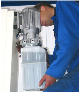
Figura 4.13 Montaje de la unidad hidráulica
