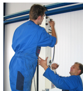
Figuur 4.12 Afstandsbussen - Montage bedieningspaneel
