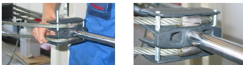
Figura 4.24 Fijación de los cables al émbolo
