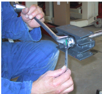
Abbildung 4.22 Montage des Plungerkopfs und Ausfahren der Kolbenstange
