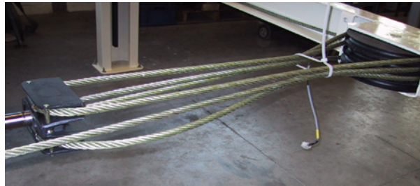
Illustration 4.23 Fixation des câbles à la tête de plongeur
