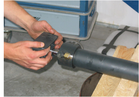
Illustration 4.22 Montage de tête de plongeur et extraction de la tige de piston
