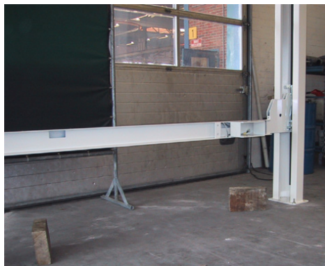
Figuur 4.11 Vastzetten van de dwarsbalken op 75 cm hoogte
