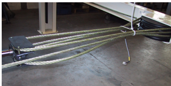
Figuur 4.23 Bevestiging van de kabels aan de plunjerkop
