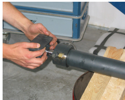
Figuur 4.22 Montage plunjerkop en uittrekken zuigerstang
