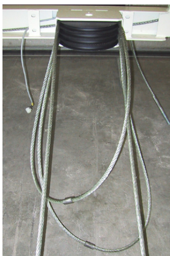
Figura 4.20 Recorrido de los cables en la barra de acoplamiento I - II y en las columnas
