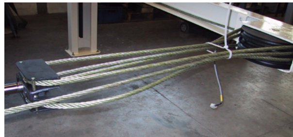
Rysunek 4.23 Zamocowanie kabli u głowicy ruchomego trzpienia
