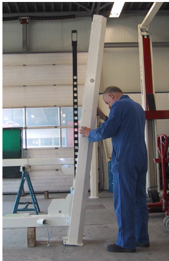
Abbildung 4.7 Einsatz der Verriegelungsprofile in die Querbalken
