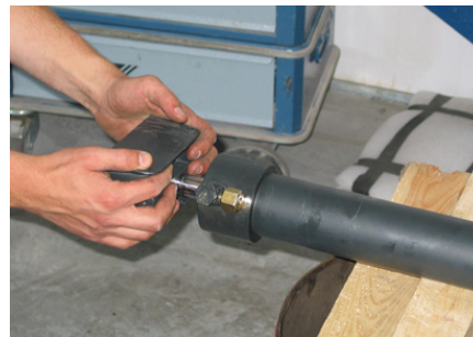
Abbildung 4.22 Montage des Plungerkopfs und Ausfahren der Kolbenstange
