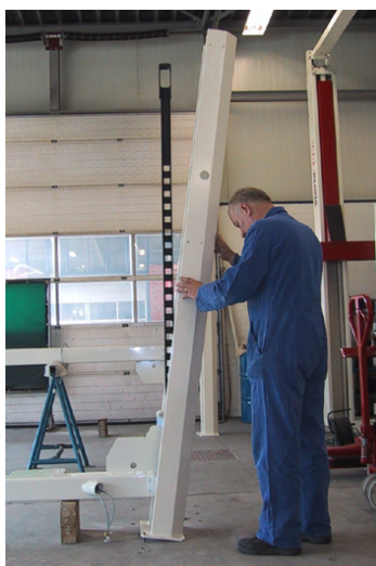
Illustration 4.7 Placement des profils de verrouillage dans les traverses
