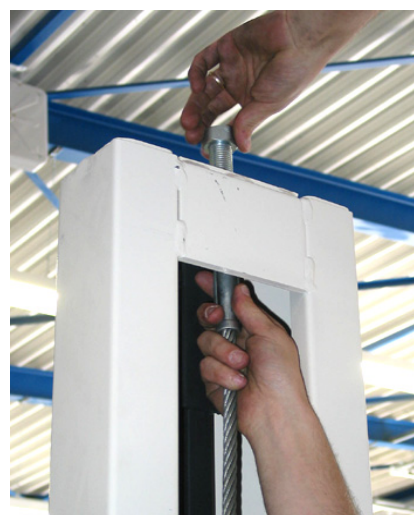
Figura 4.20 Recorrido de los cables en la barra de acoplamiento I - II y en las columnas
