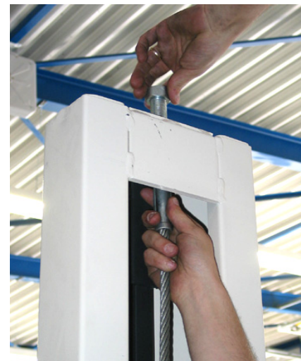
Abbildung 4.20 Seilverlauf Querbalken I - II und in den Säulen
