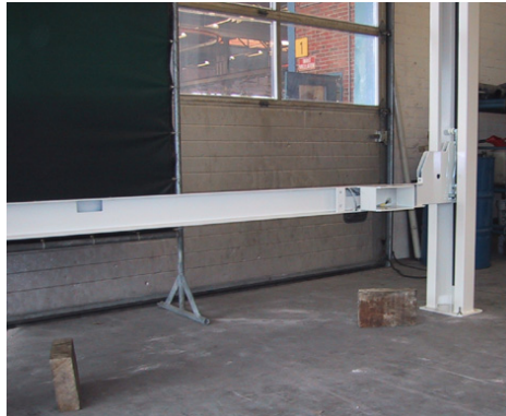
Abbildung 4.11 Fixieren des Querbalkens in 75 cm Höhe
