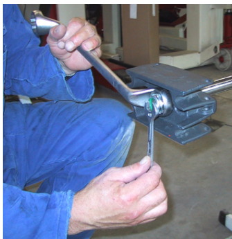
Figuur 4.22 Montage plunjerkop en uittrekken zuigerstang
