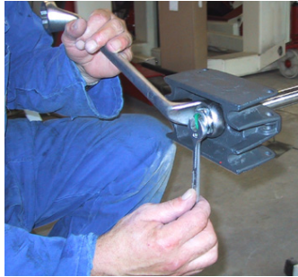
Illustration 4.22 Montage de tête de plongeur et extraction de la tige de piston
