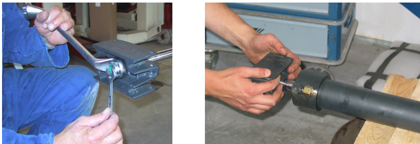
Figura 4.22 Montaje de la cabeza del émbolo y extensión del vástago del pistón
