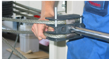
Illustration 4.24 Fixation des câbles au plongeur
