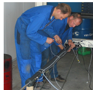
Figuur 4.25 Montage hydraulische slang en eindschakelaar
