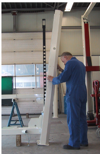
Rysunek 4.7 Umieszczenie profili blokujących w belkach poprzecznych
