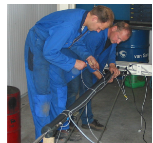
Rysunek 4.25 Montaż węża hydraulicznego i wyłącznika krańcowego.
