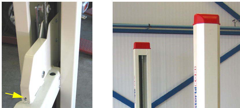
Abbildung 4.39 Schutz- und Abdeckkappen befestigen
