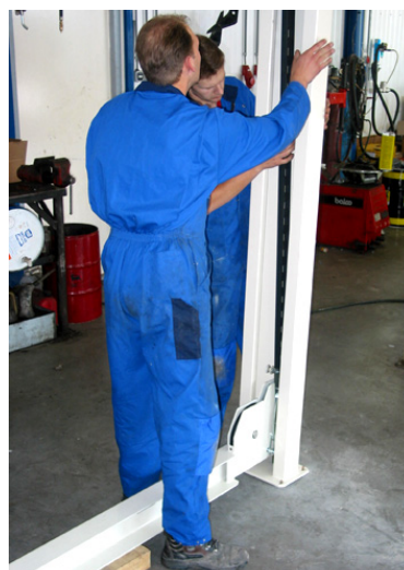
Illustration 4.7 Placement des profils de verrouillage dans les traverses
