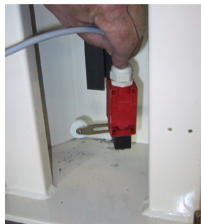
Figura 4.15 Interruptor de seguridad de los pies
