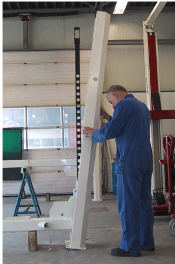
Figura 4.7 Colocación de los perfiles de bloqueo en las barras de acoplamiento
