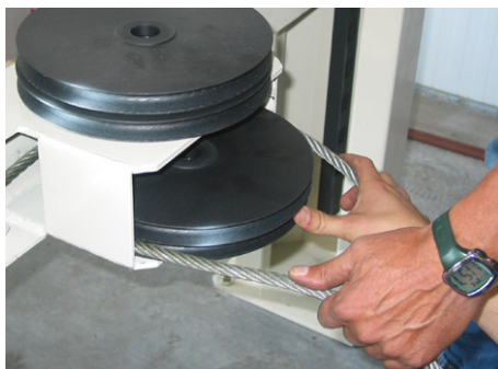
Figuur 4.17 Montage van de staalkabels
