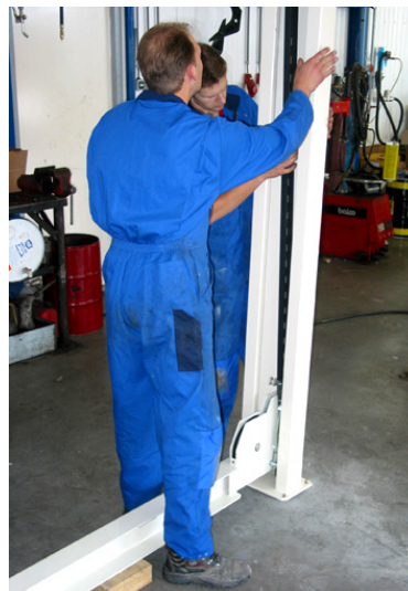
Rysunek 4.7 Umieszczenie profili blokujących w belkach poprzecznych
