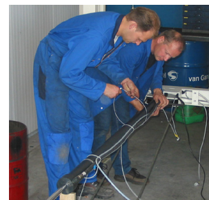
Abbildung 4.25 Montage des Hydraulikschlauchs und der Endschalter
