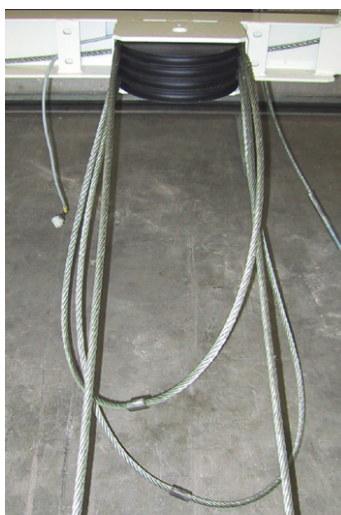
Illustration 4.20 Passage du câble de traverse I - II et dans les colonnes
