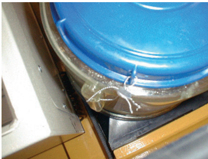
Figur 4.1. Packningen i smörjfettsbehållarens lock.
