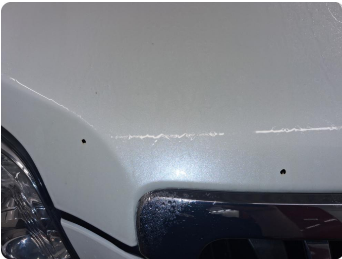
1.1 Noe steinsprut med rust Mange steinsprut med rust på panser
