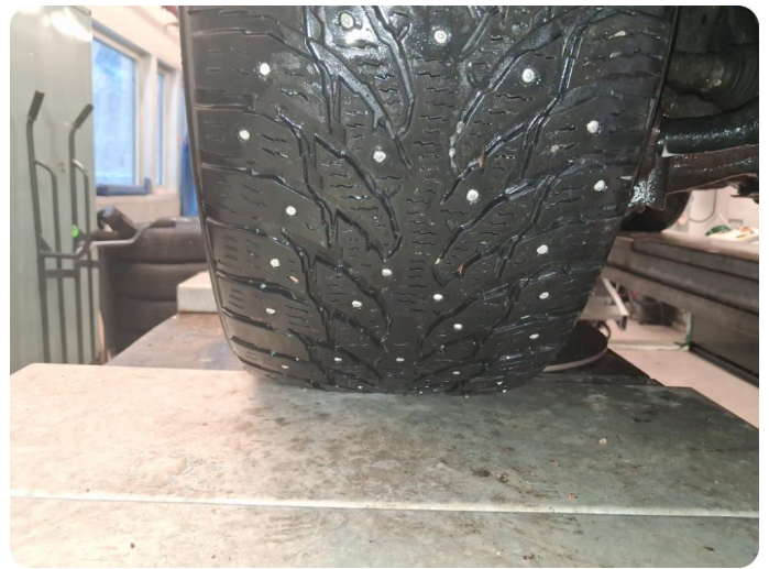
1.4 Piggdekk mangler pigger Mangler mange pigg (knekte pigger) i høyre forhjul
