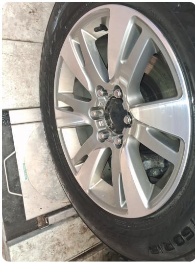
1.3 Navkopp mangler Mangler navkopp på alle vinterfelger
