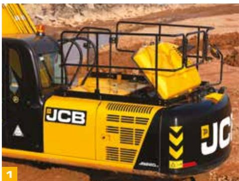
**1** O capô, assistido por cilindro, abre para trás tendo em vista maior facilidade e segurança na manutenção do motor.
