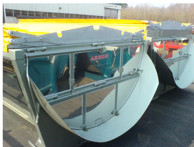
Nu som tillval - isolerad baklucka
